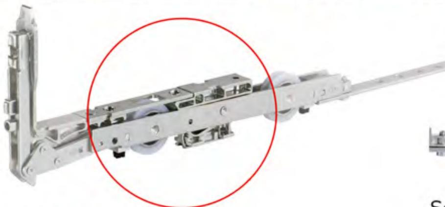
Im geschlossenen Zustand steht die Tür auf einem Kunststoffblock, das schont die Rollen bei geschlossener Tür
